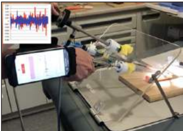
Figura 6. Modelo con acelerómetros de dispositivo iPhone 6® de Apple Inc. (83)
