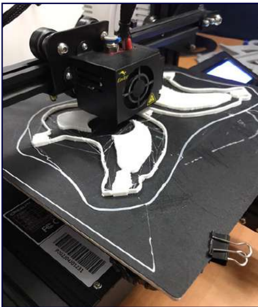
Figura 2. Proceso de impresión 3D del estómago (Fuente propia)
